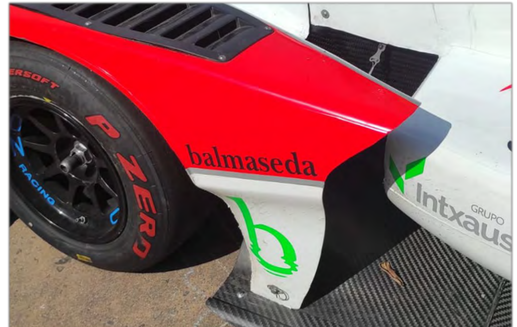
Ejemplo de conducto de aire Canalizado
