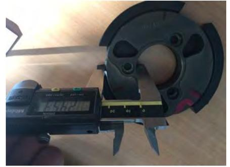
La herramienta de la imagen A permite cerrar totalmente el embrague con la ayuda de los 3 tornillos (señalados con las flechas rojas). Con el embrague totalmente cerrado se mide la altura de la zapata.
