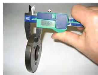
**4.7.7.2** Altura de la zapata del embrague (según la imagen siguiente). La medida no puede ser inferior a 24,10 mm. La medición se debe de realizar en las zonas de abertura de las 3 zapatas del embrague (cerca de 5 a 10mm de la muesca) y todas las zapatas del embrague deben de estar totalmente cerradas, sin ninguna abertura.
