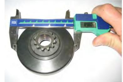
**4.7.7.4.** Diámetro interior de la campana. La medición se hace en el centro (en el área de contacto de la campana con las zapatas). El diámetro máximo interior es de 84,90 mm.
