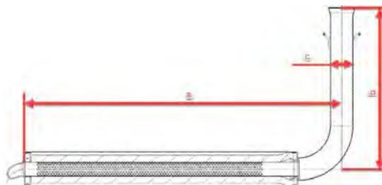
c) Una esfera de 28,0 mm de diámetro no puede pasar a través de la Sección "A" (señalada en la siguiente imagen), mientras que una esfera de diámetro de 26,0 mm debe pasar completamente a través del escape (escape sin componentes internos).
