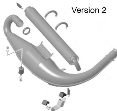
e) El escape no puede ser modificado excepto para reemplazar el material absorbente del silencioso y el uso de grapas de rosca en lugar de remaches para asegurar el capuchón del final del silencioso
