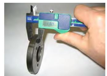
**4.7.7.2** Altura de la zapata del embrague (según la imagen siguiente). La medida no puede ser inferior a 24,10 mm. La medición se debe de realizar en las zonas de abertura de las 3 zapatas del embrague (cerca de 5 a 10mm de la muesca) y todas las zapatas del embrague deben de estar totalmente cerradas, sin ninguna abertura.
