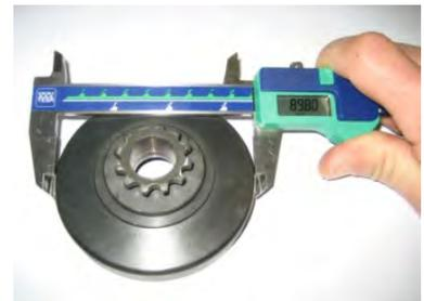
**4.7.7.4.** Diámetro interior de la campana. La medición se hace en el centro (en el área de contacto de la campana con las zapatas). El diámetro máximo interior es de 84,90 mm.
