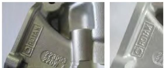
**4.3.1.4 cilindro MAX FR** tiene en su configuración una lumbrera de escape principal y una válvula de escape electrónica y marcado con la identificación 223993
