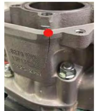
b) Cavidad de la válvula de escape. Se permite reparar solo el área marcada en rojo en la siguiente imagen, o sea, el área que está dañada por el desgaste del contacto entre la válvula de escape y el cilindro. También se permite maquinar/ pulir el área reparada (marcada en rojo), para restaurar el cilindro a sus especificaciones originales. Queda terminantemente prohibido retirar material adicional en el área circundante de la zona de reparación.
