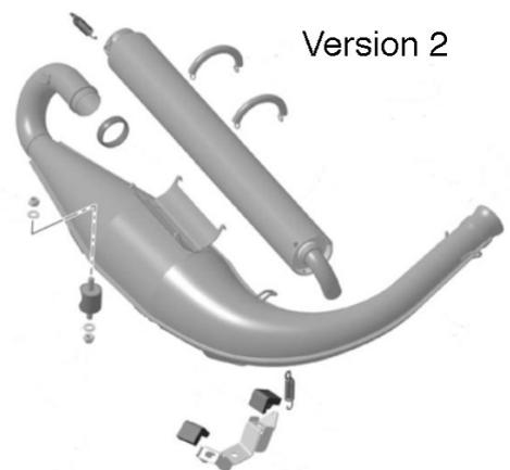
**e)** El escape no puede ser modificado excepto para reemplazar el material absorbente del silencioso y el uso de grapas de rosca en lugar de remaches para asegurar el capuchón del final del silencioso
