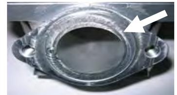
**4.3.4** Altura del cilindro = 87,00 mm (-0,05/+0,1 mm).
